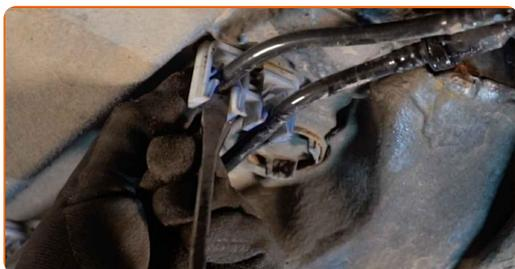
**7** Drücken Sie die Clips zusammen und lösen Sie die Kraftstoffzufuhrleitungen vom Kraftstofffiltergehäuse. Verwenden Sie Kraftstoffleitungszangen. Benutzen Sie ein Brecheisen.
