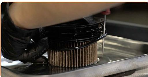
**14** Entfernen Sie den Kraftstofffilter.
