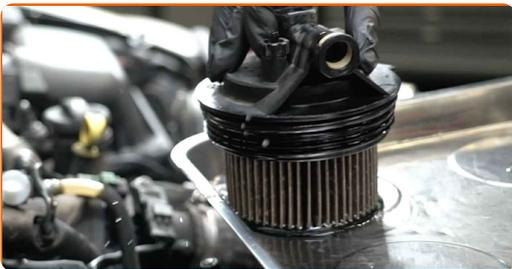
**12** Pumpen Sie den Kraftstoff aus dem Kraftstofffiltergehäuse. Verwenden Sie eine manuelle Absaugpumpe.
