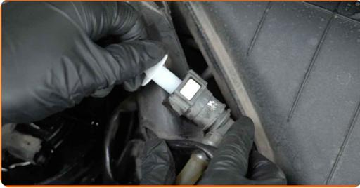
**8** Schrauben Sie die Befestigungen vom Deckel des Kraftstofffiltergehäuses ab. Verwenden Sie Stecknuss Nr. 27. Verwenden Sie einen Ratschenschlüssel.
