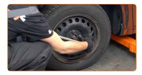
Entfernen Sie den Wagenheber sowie die Unterlegkeile.
