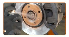
Die Bremsscheibenoberfläche reinigen. Benutzen Sie einen Bremsenreiniger.
