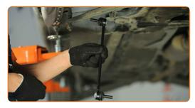
Ziehen Sie das Befestigungselement an, das die Druckstange mit dem Stabilisator verbindet. Verwenden Sie Ring-Gabelschlüssel Nr. 19. Verwenden Sie Inbusschlüssel Nr. H6. Verwenden Sie einen Drehmomentschlüssel. Ziehen Sie ihn mit 65 Nm Drehmoment fest.
