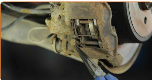
**8** Entfernen Sie die Halteclips der Bremsbeläge. Verwenden Sie einen Splintentreiber. Benutzen Sie einen Hammer.
