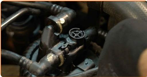
**18** Verbinden Sie die Kraftstoffversorgungsleitungen zum Kraftstofffilter.
