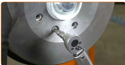
**42** Behandeln Sie die Oberfläche, an der die Radfelge die Bremstrommel berührt. Verwenden Sie Keramikfett.
