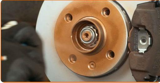
67 Die Bremsscheibenoberfläche reinigen. Benutzen Sie einen Bremsenreiniger.
