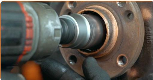
**15** Entfernen Sie die Befestigungsmutter.
