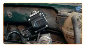
Ziehen Sie die Zündspulen Befestigung an. Verwenden Sie Stecknuss Nr. 10. Verwenden Sie einen Drehmomentschlüssel. Ziehen Sie ihn mit 7 Nm Drehmoment fest.
