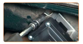
Behandeln Sie den Zündspulenanschluss mit einem Elektronikspray. Das Spray wird die elektrischen Kontakte vor Korrosion und Oxidation schützen und den Kontaktwiderstand reduzieren.
