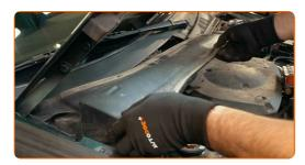
Bauen Sie die Dichtung der Windabweiserabdeckung ein.
