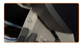
Entfernen Sie das Luftfiltergehäuse.
