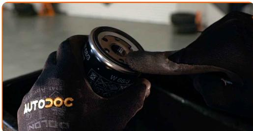
**14** Schrauben Sie den neuen Filter in seinen Platz. Verwenden Sie Steckschlüssel 76-14F. Verwenden Sie einen Drehmomentschlüssel. Ziehen Sie ihn mit 23 Nm Drehmoment fest.
