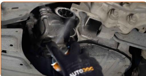
**13** Schmieren Sie die Gummidichtung des neuen Filters mit einer kleinen Menge frischen Öls.
