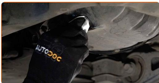
**16** Schrauben Sie die neue Ablassschraube ein und ziehen Sie sie fest. Verwenden Sie Stecknuss Nr. 14. Verwenden Sie einen Drehmomentschlüssel. Ziehen Sie ihn mit 27 Nm Drehmoment fest.
