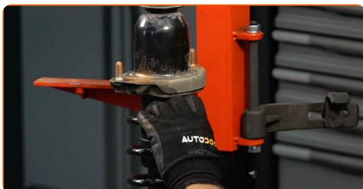
**45** Reinigen Sie die Anbringungssitze des Federbeins. Benutzen Sie eine Drahtbürste. Benutzen Sie WD-40-Spray.
