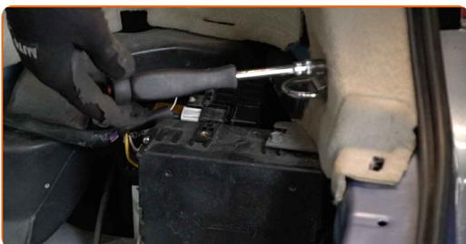
**60** Schrauben Sie das Befestigungselement der Seitenauskleidung des Kofferraums ein. Verwenden Sie Stecknuss Nr. 10. Verwenden Sie einen Ratschenschlüssel.
