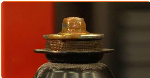
**43** Dekomprimieren Sie die Feder.
