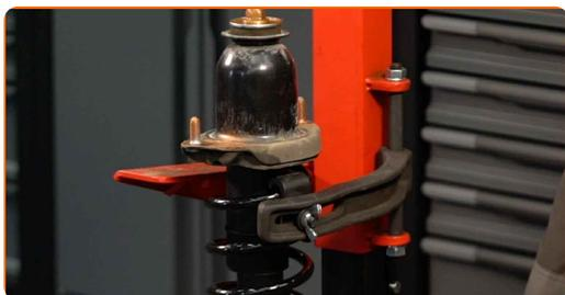
**44** Entfernen Sie das zusammengebaute Federbein.
