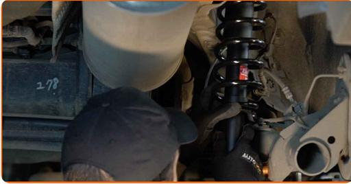
**48** Schrauben Sie die obere Befestigung des Domlagers an. Schrauben Sie diese nicht fest.
