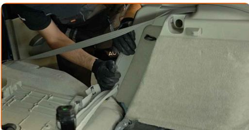
**63** Bringen Sie die zentrale Schutzverkleidung aus Kunststoff an.
