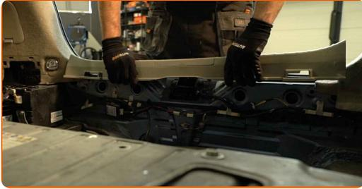
**15** Schrauben Sie das Befestigungselement heraus und entfernen Sie die Schalldämmung an der Kofferraumseite. Verwenden Sie Stecknuss Nr. 10. Verwenden Sie einen Ratschenschlüssel.
