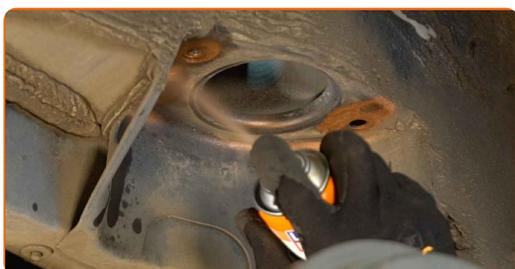
**47** Installieren Sie das Federbein am Radlauf.
