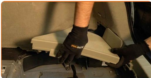
**10** Entfernen Sie die Seitenabdeckung aus Kunststoff.
