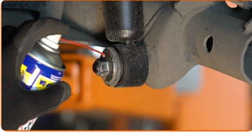
**24** Untere Befestigung der Stoßdämpferfedern abschrauben. Verwenden Sie Stecknuss Nr. 19. Verwenden Sie einen Ratschenschlüssel.
