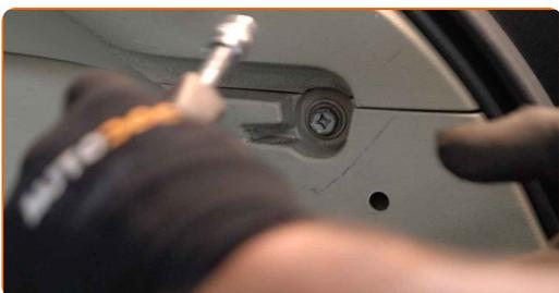
**61** Schrauben Sie die Befestigungen der Kunststoffplatten der Seitenverkleidung ein. Verwenden Sie Stecknuss Nr. 10. Verwenden Sie einen Ratschenschlüssel.
