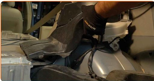
**17** Lösen Sie die obere Befestigung des Domlagers. Verwenden Sie Stecknuss Nr. 14. Verwenden Sie einen Ratschenschlüssel.
