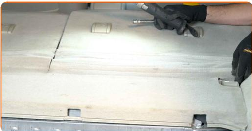
**64** Schrauben Sie das Befestigungselement der zentralen Schutzverkleidung aus Kunststoff ein. Verwenden Sie Stecknuss Nr. 10. Verwenden Sie einen Ratschenschlüssel.
