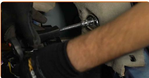
**16** Lösen Sie den Luftschlauch der Heizung.
