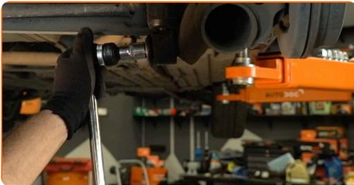
**25** Lösen Sie die obere Befestigung des Domlagers. Verwenden Sie Stecknuss Nr. 14. Verwenden Sie einen Ratschenschlüssel.
