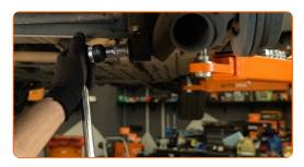
Lösen Sie die obere Befestigung des Domlagers. Verwenden Sie Stecknuss Nr. 14. Verwenden Sie einen Ratschenschlüssel.
