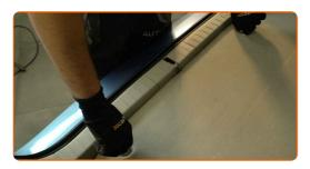
Entfernen Sie die untere Auskleidung des vorderen Kofferraumbereichs.
