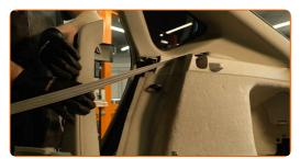
Schrauben Sie die Befestigungen der Kunststoffplatten der Seitenverkleidung heraus. Verwenden Sie Stecknuss Nr. 10. Verwenden Sie einen Ratschenschlüssel.
