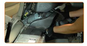
Bringen Sie die Schalldämmung an der Kofferraumseite an und schrauben Sie die zugehörigen Befestigungen ein. Verwenden Sie Stecknuss Nr. 10. Verwenden Sie einen Ratschenschlüssel.
