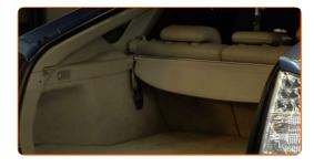
Bewegen Sie das Faltregal und lösen Sie es von den Halterungen. Auf diese Weise erlangen Sie Zugang zu den Kunststoffplatten der Außenverkleidung.
