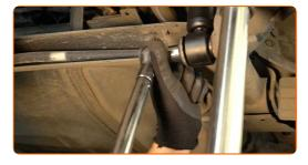
Die Montage unter dem Hinterachsträger entfernen.
