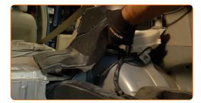
Lösen Sie die obere Befestigung des Domlagers. Verwenden Sie Stecknuss Nr. 14. Verwenden Sie einen Ratschenschlüssel.
