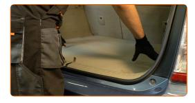
Bringen Sie die Clips der unteren Auskleidung des vorderen Kofferraumbereichs an.
