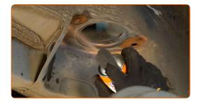
Installieren Sie das Federbein am Radlauf.
