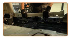
Schrauben Sie das Befestigungselement heraus und entfernen Sie die Schalldämmung an der Kofferraumseite. Verwenden Sie Stecknuss Nr. 10. Verwenden Sie einen Ratschenschlüssel.
