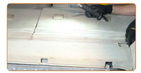
Schrauben Sie das Befestigungselement der zentralen Schutzverkleidung aus Kunststoff ein. Verwenden Sie Stecknuss Nr. 10. Verwenden Sie einen Ratschenschlüssel.
