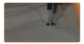
Heben Sie die zentrale Plastikabdeckung (die Batterieabdeckung).
