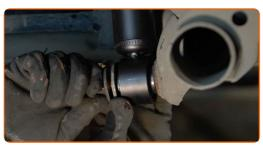
Stützen Sie die Verbundlenkerachse. Benutzen Sie einen hydraulischen Getriebeheber.
