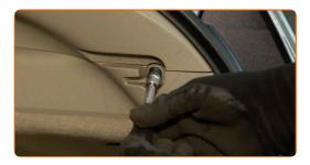
Entfernen Sie die Sicherheitsgurt-Verkleidung.
