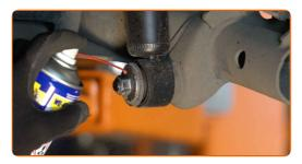
Untere Befestigung der Stoßdämpferfedern abschrauben. Verwenden Sie Stecknuss Nr. 19. Verwenden Sie einen Ratschenschlüssel.
