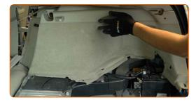
Schrauben Sie das Befestigungselement der Seitenauskleidung des Kofferraums ein. Verwenden Sie Stecknuss Nr. 10. Verwenden Sie einen Ratschenschlüssel.
