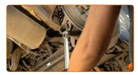
Ziehen Sie die untere Befestigung des Stoßdämpfers an. Verwenden Sie Stecknuss Nr. 19. Verwenden Sie einen Drehmomentschlüssel. Ziehen Sie ihn mit 80 Nm Drehmoment fest.
