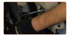
Lösen Sie den Luftschlauch der Heizung.
