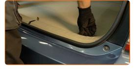
67 Setzen Sie die untere Kofferraumverkleidung ab.
