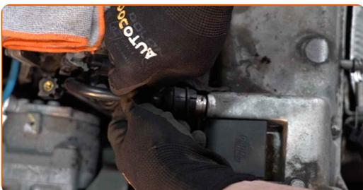
**20** Entfernen Sie das Mikrofasertuch von der Drosselklappe.
