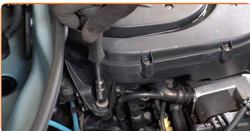
**4** Entfernen Sie die Haltefeder des Luftfiltergehäuses.
