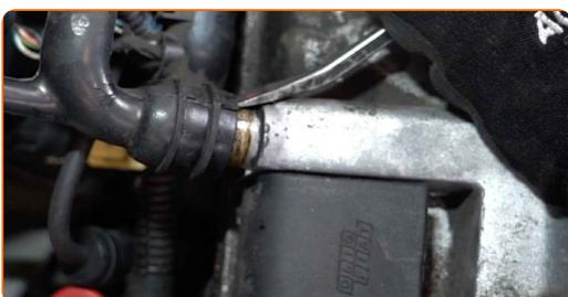
**8** Lösen Sie den Drosselklappenstecker. Benutzen Sie ein Brecheisen.
