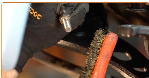
**13** Schrauben Sie einen neuen Spurstangenkopf an.
