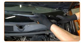
Entfernen Sie die Befestigungsclips der Windlaufabdeckung. Verwenden Sie einen Lösehebel, um die Clips zu entfernen.
