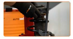
Ziehen Sie die Federbeinkolbenstangenmutter an. Verwenden Sie Inbusschlüssel Nr. H6. Verwenden Sie Stecknuss Nr. 18. Verwenden Sie einen Drehmomentschlüssel. Ziehen Sie ihn mit 62 Nm Drehmoment fest.
