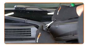
Lösen Sie die Befestigungen der Frontscheibenwischerarme. Verwenden Sie Stecknuss Nr. 14. Verwenden Sie einen Ratschenschlüssel.
