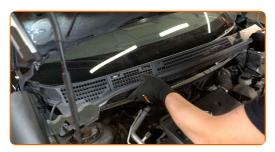
Trennen Sie den Waschdüsenschlauch der Windschutzscheibe.
