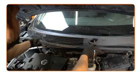
Bringen Sie die Befestigungselemente der Windlaufabdeckung an.
