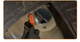
Installieren Sie das Federbein am Radlauf.
