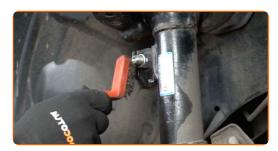
Schrauben Sie das Befestigungselement heraus, das die Druckstange mit dem Federbein verbindet. Verwenden Sie Stecknuss Nr. 19. Verwenden Sie einen Ratschenschlüssel.
