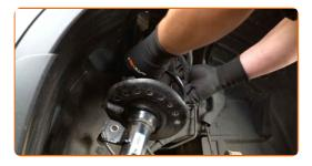
Stellen Sie das Dämpferbein auf das Federspannwerkzeug.
