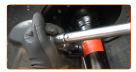
Ziehen Sie die unteren Befestigungen an, die das Federbein mit dem Achsschenkel verbinden. Verwenden Sie Stecknuss Nr. 21. Verwenden Sie einen Drehmomentschlüssel. Ziehen Sie ihn mit 168 Nm Drehmoment fest.
