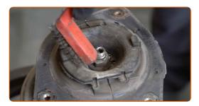
Entfernen Sie die Stangenmutter des Federkolben. Verwenden Sie Inbusschlüssel Nr. H6. Verwenden Sie Stecknuss Nr. 18. Verwenden Sie einen Ratschenschlüssel.
