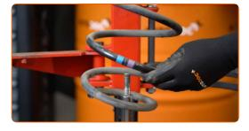
Installieren Sie die Feder am Stoßdämpfer.
