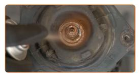
Entfernen Sie das zusammengebaute Federbein.
