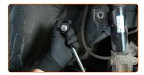
Entfernen Sie das Befestigungselement, mit dem der Bremsschlauch am Federbein befestigt ist. Benutzen Sie ein Brecheisen.
