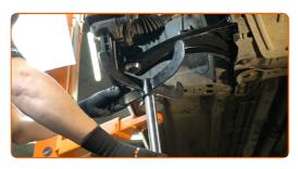
Entfernen Sie die Befestigungsschrauben.
