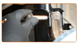
Entfernen Sie den Träger unter dem Achsschenkel.
