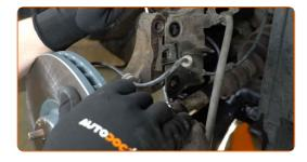
Entfernen Sie den Träger unter dem Achsschenkel.
