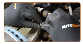
Den Halteclip des Bremsschlauchs anbringen. Benutzen Sie einen Hammer.
