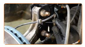
Befestigen Sie den Bremsschlauch an der Strebe.
