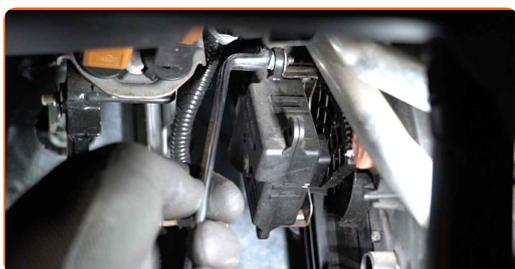
**8** Entfernen Sie den Heizungsstellmotor.
