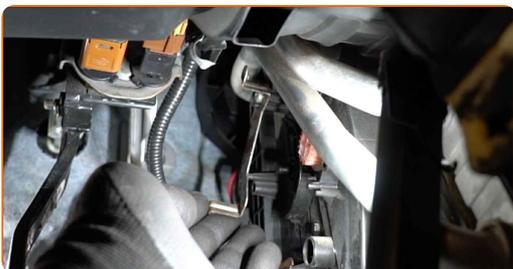
**12** Entfernen Sie den Gehäusedeckel des Innenraumfilters.
