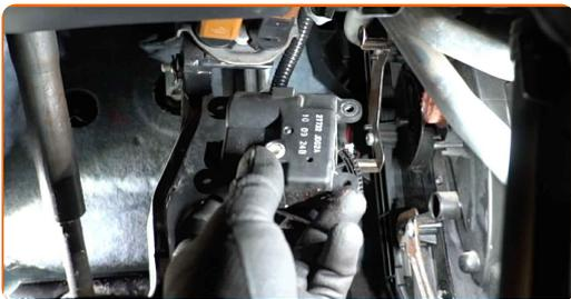
**9** Lösen Sie den Steckverbinder des Heizungsstellmotors.
