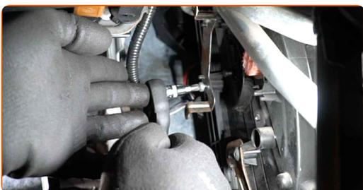
**11** Entfernen Sie die Halterung des Heizungsstellmotors.
