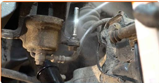
**18** Behandeln Sie die Bremssattel-Führungsstifte. Verwenden Sie das Bremssattelführungsbolzen-Fett.
