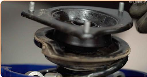
27 Ziehen Sie die Federbeinkolbenstangenmutter an. Verwenden Sie Stecknuss Nr. 18. Verwenden Sie Ring-Gabelschlüssel Nr. 18. Verwenden Sie Inbusschlüssel Nr. H7. Verwenden Sie einen Drehmomentschlüssel. Ziehen Sie ihn mit 64 Nm Drehmoment fest.
