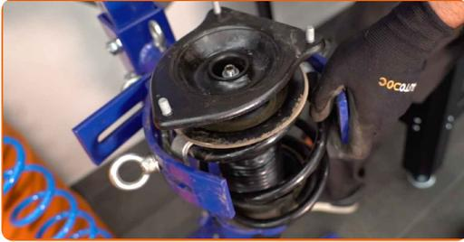
29 Entfernen Sie das zusammengebaute Federbein.
