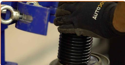
25 Installieren Sie die Feder am Stoßdämpfer.
