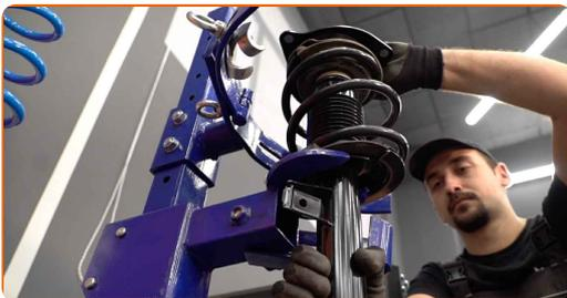
23 Installieren Sie das Federbein am Radlauf.
