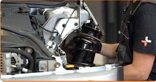
24 Sichern Sie die oberen Befestigungen des Federbeines (3 Stück). Schrauben Sie diese nicht fest.
