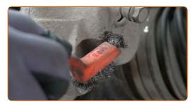
Schrauben Sie die Befestigungen des Bremssattels ab. Verwenden Sie Ring-Gabelschlüssel Nr. 14.
