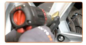
Senken Sie das Auto und ziehen Sie die Radschrauben über Kreuz an. Verwenden Sie eine Schlagnuss für Felgen # 19. Verwenden Sie einen Drehmomentschlüssel. Ziehen Sie ihn mit 103 Nm Drehmoment fest.
