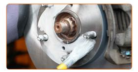
Die Bremsscheibenoberfläche reinigen. Benutzen Sie einen Bremsenreiniger.
