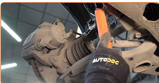
7 Schrauben Sie das Befestigungselement heraus, das die Druckstange mit dem Stabilisator verbindet. Verwenden Sie Stecknuss Nr. 17. Verwenden Sie ein Windeisen.
