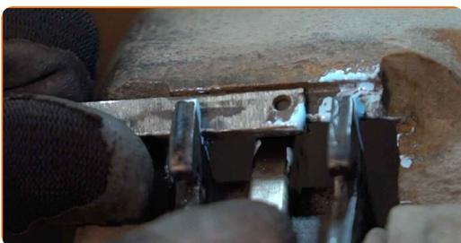
**14** Bringen Sie die Haltefeder des Bremsbelags an. Verwenden Sie eine Rundzange.
