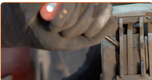
**8** Entfernen Sie die Haltefeder des Bremsbelags. Benutzen Sie ein Brecheisen.
