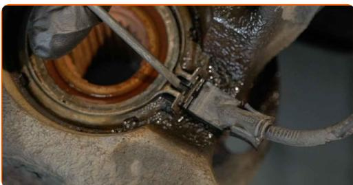
**38** Entfernen Sie die Radnabe vom Achsschenkel. Verwenden Sie einen Splintentreiber. Benutzen Sie einen Hammer.
