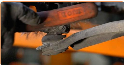
**22** Schrauben Sie die Kugelgelenkbefestigung vom Achsschenkel ab. Verwenden Sie Ring-Gabelschlüssel Nr. 16. Verwenden Sie Stecknuss Nr. 16. Verwenden Sie ein Windeisen.
