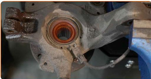
**36** Reinigen Sie die Befestigung des ABS-Sensors. Benutzen Sie eine Drahtbürste. Benutzen Sie WD-40-Spray.
