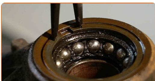
**42** Reinigen Sie den Einbauort für die Nabenlagerung. Benutzen Sie eine Drahtbürste. Benutzen Sie WD-40-Spray.
