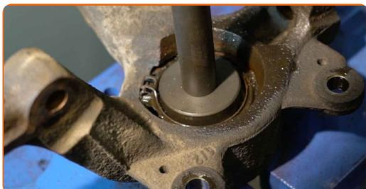
**45** Reinigen Sie den Einbauort für die Nabenlagerung. Benutzen Sie eine Drahtbürste. Benutzen Sie WD-40-Spray.
