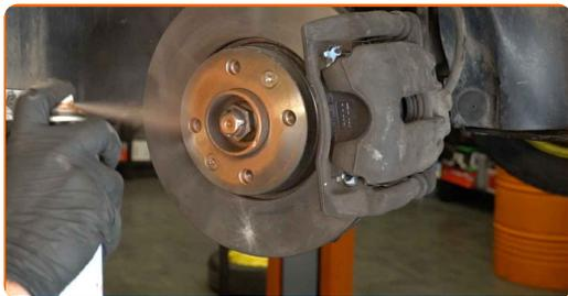
**77** Die Bremsscheibenoberfläche reinigen. Benutzen Sie einen Bremsenreiniger.
