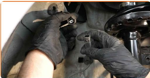
**21** Reinigen Sie alle Verbindungen des Querlenkers. Benutzen Sie eine Drahtbürste. Benutzen Sie WD-40-Spray.
