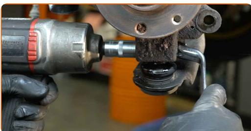
**23** Entfernen Sie die Befestigungsschraube.
