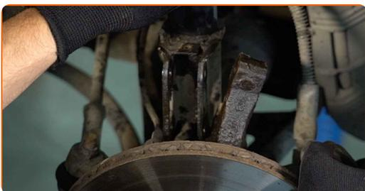
**15** Lösen Sie die obere Befestigung des Domlagers. Verwenden Sie Stecknuss Nr. 21.
