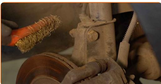
**11** Schrauben Sie das untere Befestigungselement ab, das das Federbein mit dem Achsschenkel verbindet. Verwenden Sie Ring-Gabelschlüssel Nr. 18. Verwenden Sie Stecknuss Nr. 18. Verwenden Sie ein Windeisen.
