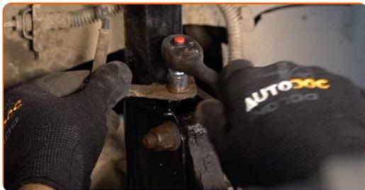
**39** Ziehen Sie die unteren Befestigungen an, die das Federbein mit dem Achsschenkel verbinden. Verwenden Sie Ring-Gabelschlüssel Nr. 18. Verwenden Sie Stecknuss Nr. 18. Verwenden Sie einen Drehmomentschlüssel. Ziehen Sie ihn mit 110 Nm Drehmoment fest.
