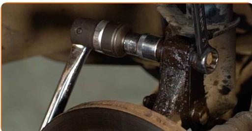
**12** Schrauben Sie den ABS-Kabelhalter ab. Verwenden Sie Stecknuss Nr. 10. Verwenden Sie einen Ratschenschlüssel.
