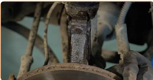
**14** Ziehen Sie den Achsschenkel vom Dämpferbein ab. Verwenden Sie Ring-Gabelschlüssel Nr. 18.
