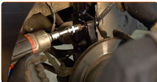
**38** Ziehen Sie den ABS-Kabelhalter an. Verwenden Sie Stecknuss Nr. 10. Verwenden Sie einen Ratschenschlüssel.
