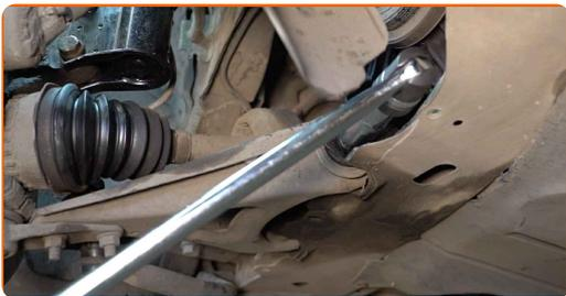
**13** Befestigen Sie die Stabilisatorstange. Verwenden Sie Stecknuss Nr. 13.
