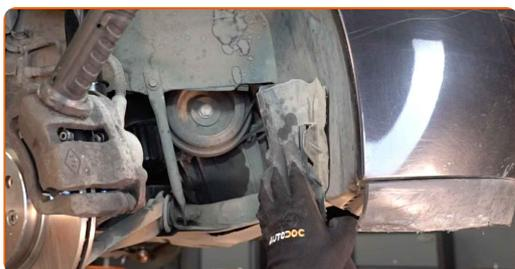
7 Reinigen Sie die Befestigungselemente des Bewehrungsstabs des Stoßfängers und dessen Halterung. Benutzen Sie eine Drahtbürste. Benutzen Sie WD-40-Spray.
