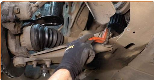
**12** Schrauben Sie die vordere Armbefestigung ab. Verwenden Sie Stecknuss Nr. 18. Verwenden Sie ein Windeisen.
