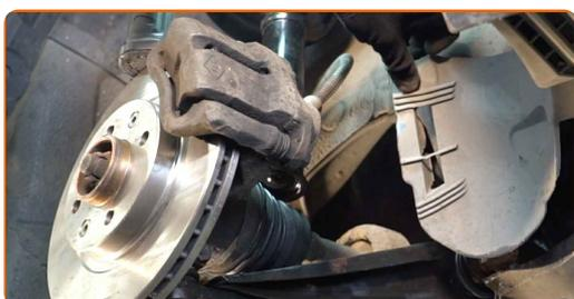
**44** Montieren Sie den Querlenker. Benutzen Sie ein Brecheisen.
