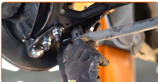
**45** Ziehen Sie die Befestigungselemente des Stabilenkers fest. Verwenden Sie den Torx T40. Verwenden Sie Stecknuss Nr. 13. Verwenden Sie einen Drehmomentschlüssel. Ziehen Sie ihn mit 14 Nm Drehmoment fest.
