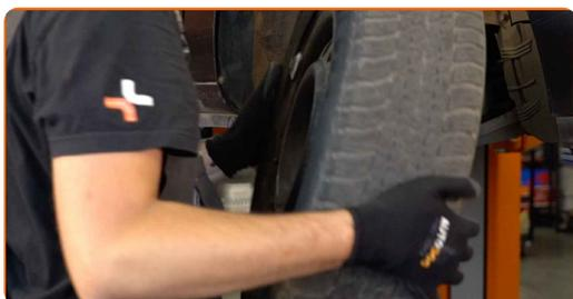
6 Schrauben Sie die Verbindungselemente der Radkastenabdeckung ab. Legen Sie das Teil beiseite.
