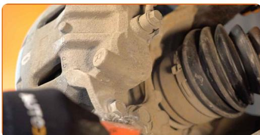
**8** Schrauben Sie die Befestigung des Bremssattels ab. Verwenden Sie Ring-Gabelschlüssel Nr. 17. Verwenden Sie Stecknuss Nr. 14. Verwenden Sie einen Ratschenschlüssel.
