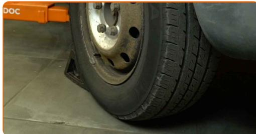
**2** Lösen Sie die Radschrauben. Verwenden Sie eine Schlagnuss für Felgen mit einem Durchmesser von 24 mm. Verwenden Sie einen Drehstift.
