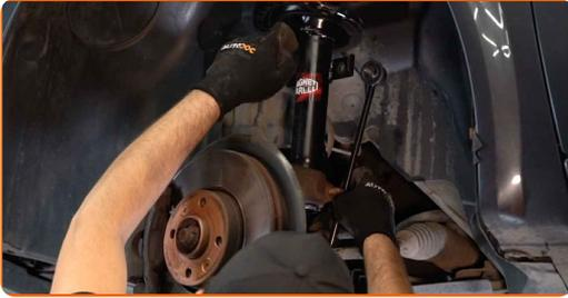
**11** Ziehen Sie das Befestigungselement an, das die Druckstange mit dem Federbein verbindet. Verwenden Sie Stecknuss Nr. 14. Verwenden Sie Ring-Gabelschlüssel Nr. 15. Verwenden Sie einen Drehmomentschlüssel. Ziehen Sie ihn mit 44 Nm Drehmoment fest.
