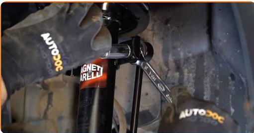
**12** Ziehen Sie das Befestigungselement an, das die Druckstange mit dem Stabilisator verbindet. Verwenden Sie Stecknuss Nr. 14. Verwenden Sie Ring-Gabelschlüssel Nr. 15. Verwenden Sie einen Drehmomentschlüssel. Ziehen Sie ihn mit 44 Nm Drehmoment fest.
