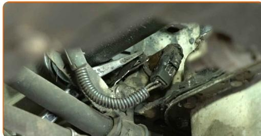
**3** Entfernen Sie den Kurbelwellensensor.
