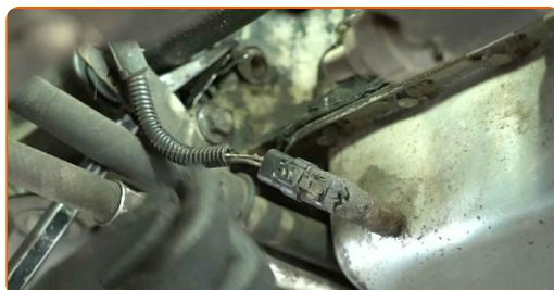
**4** Entfernen Sie die Haltefeder des Kurbelwellensensors.
