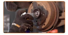
Schrauben Sie die Radnaben-Achsmutter ab. Verwenden Sie Stecknuss Nr. 30. Verwenden Sie ein Windeisen.
