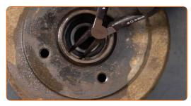
Drücken Sie das Radnabenlager heraus. Verwenden Sie einen Druckstücksatz mit Ein-/Auspresswerkzeug.
