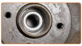
Reinigen Sie den Einbauort für die Nabenlagerung. Verwenden Sie Allzweckreinigungsspray.
