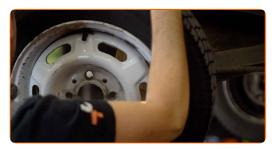
Reinig de remtrommel. Benutzen Sie eine Drahtbürste. Benutzen Sie WD-40-Spray.
