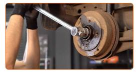
Entfernen Sie die Bremstrommel.
