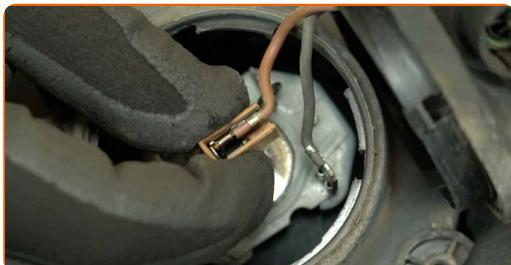
**10** Ziehen Sie die Halteklammer der Nebelscheinwerferlampe beiseite.
