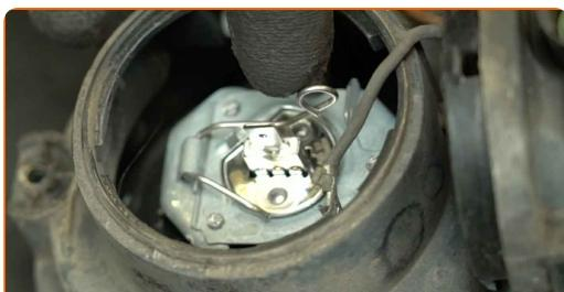
**11** Entfernen Sie die Nebelscheinwerferlampe.
