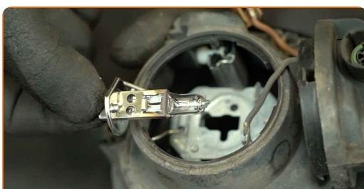
**12** Setzen Sie die Glühlampe in den neuen Nebelscheinwerfer ein.
