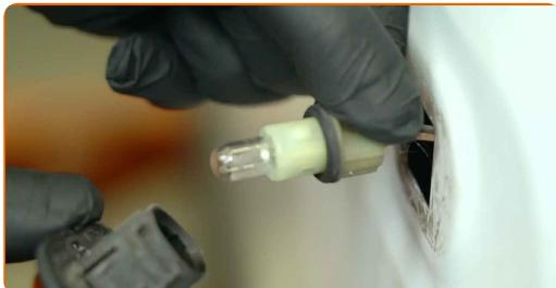
3 Befestigen Sie die Lampenfassung an einem neuen Seitenblinker.
