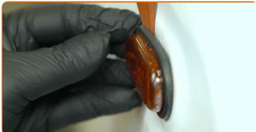
2 Lösen Sie die Lampenfassung vom Seitenblinker.
