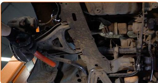
7 Befestigen Sie die Stabilisatorstange. Verwenden Sie Stecknuss Nr. 13. Verwenden Sie einen Ratschenschlüssel.
