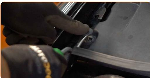
**4** Entfernen Sie die Dichtung der Windabweiserabdeckung.
