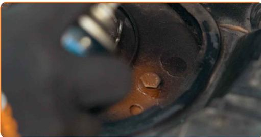
62 Setzen Sie die Federbeinlagerkappe auf.
