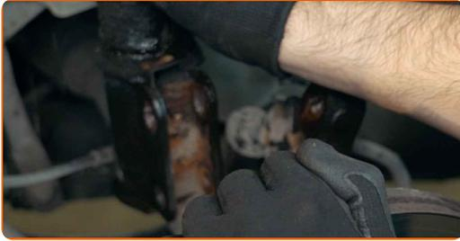
23 Lösen Sie die obere Befestigung der Federbeinbefestigung.
