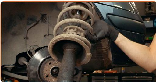
25 Stellen Sie das Dämpferbein auf das Federspannwerkzeug.
