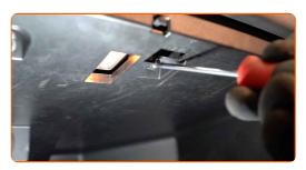
Entfernen Sie die seitliche Abdeckung des Armaturenbretts.
