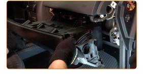
Schrauben Sie die Befestigungsschrauben des Handschuhfaches fest. Verwenden Sie den Torx T20.
