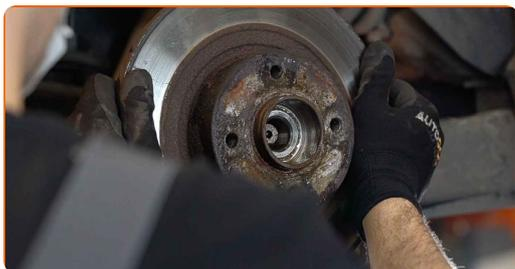
**20** Reinigen Sie die Führungsschienen des Achszapfens. Benutzen Sie eine Drahtbürste. Benutzen Sie WD-40-Spray.
