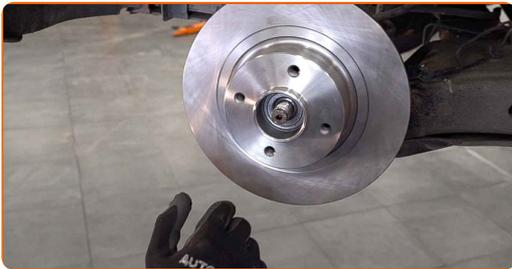
**22** Ziehen Sie die Nabe hindurch. Verwenden Sie Stecknuss Nr. 30. Verwenden Sie einen Drehmomentschlüssel. Ziehen Sie ihn mit 220 Nm Drehmoment fest.
