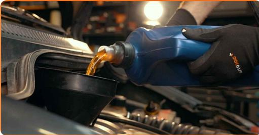
Austausch: Motoröl und Ölfilter – RENAULT Megane II Schrägheck (BM, CM).
