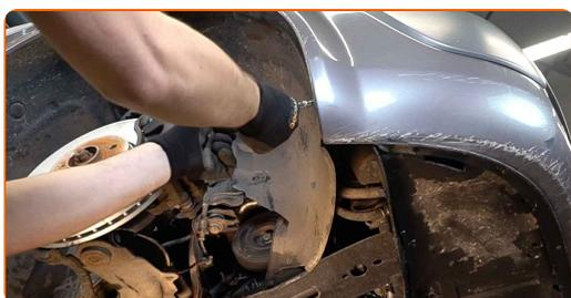
**9** Entfernen Sie die Radkastenabdeckung.
