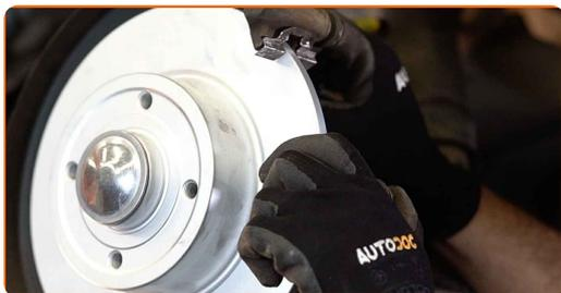
**24** Befestigen Sie die Bremssattelhalterung. Verwenden Sie Stecknuss Nr. E16. Verwenden Sie einen Drehmomentschlüssel. Ziehen Sie ihn mit 105 Nm Drehmoment fest.
