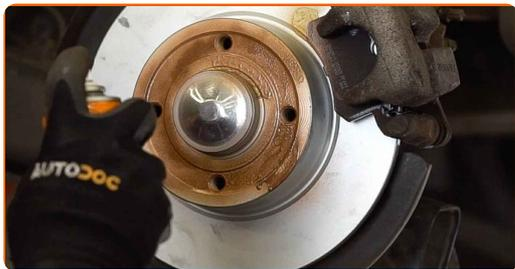
**29** Die Bremsscheibenoberfläche reinigen. Benutzen Sie eine Drahtbürste. Benutzen Sie einen Bremsenreiniger.
