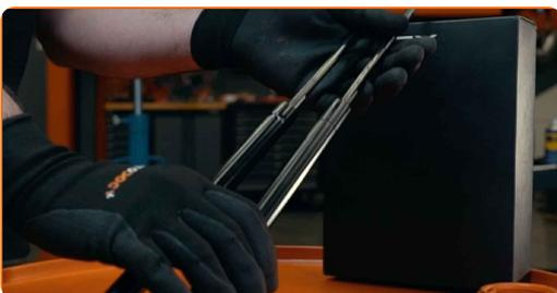
Austausch: Heckklappendämpfer – RENAULT Scénic I (JA0/1, FA0). Tipp von AUTODOC:
