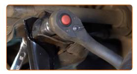
Schrauben Sie die vordere Armbefestigung an. Verwenden Sie Ring-Gabelschlüssel Nr. 18. Verwenden Sie Stecknuss Nr. 18. Verwenden Sie ein Windeisen.
