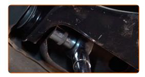
Ziehen Sie das vordere Befestigungselement an, das den Querlenker mit dem Hilfsrahmen verbindet. Verwenden Sie Ring-Gabelschlüssel Nr. 18. Verwenden Sie Stecknuss Nr. 18. Verwenden Sie einen Drehmomentschlüssel. Ziehen Sie ihn mit 115 Nm Drehmoment fest.
