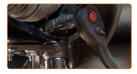
Schrauben Sie das hintere Befestigungselement ein, das den Querlenker mit dem Hilfsrahmen verbindet.
