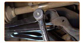
Ziehen Sie das Kugelgelenk an. Verwenden Sie Ring-Gabelschlüssel Nr. 16. Verwenden Sie Stecknuss Nr. 16. Verwenden Sie einen Drehmomentschlüssel. Ziehen Sie ihn mit 62 Nm Drehmoment fest.
