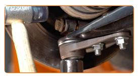
Schrauben Sie die Befestigungen des Kugelgelenks ein. Verwenden Sie Stecknuss Nr. 16. Verwenden Sie Ring-Gabelschlüssel Nr. 16.
