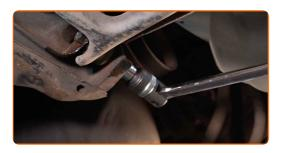
Entfernen Sie die Befestigungsschraube.
