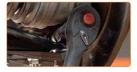
Entfernen Sie den Träger unter dem Arm.
