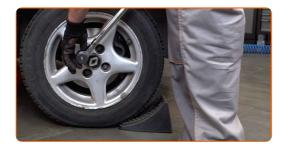
Entfernen Sie den Wagenheber sowie die Unterlegkeile.
