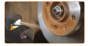
Die Bremsscheibenoberfläche reinigen. Benutzen Sie einen Bremsenreiniger.
