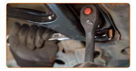
Schrauben Sie die vordere Armbefestigung an. Verwenden Sie Ring-Gabelschlüssel Nr. 18. Verwenden Sie Stecknuss Nr. 18. Verwenden Sie ein Windeisen.
