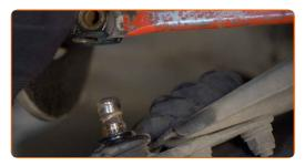
Reinigen Sie alle Verbindungen des Querlenkers. Benutzen Sie eine Drahtbürste. Benutzen Sie WD-40-Spray.
