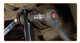
Verbinden Sie den Unterarm mit dem Achsschenkel.
