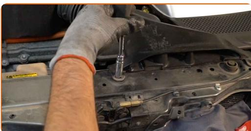
**18** Schrauben Sie die Befestigungsklemme ein, die das Luftkanal-Gehäuse mit dem Luftfilter-Gehäuse verbindet. Verwenden Sie Stecknuss Nr. 10. Verwenden Sie einen Ratschenschlüssel.
