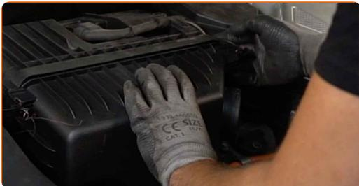
**16** Bringen Sie das Luftkanal-Gehäuse an.
