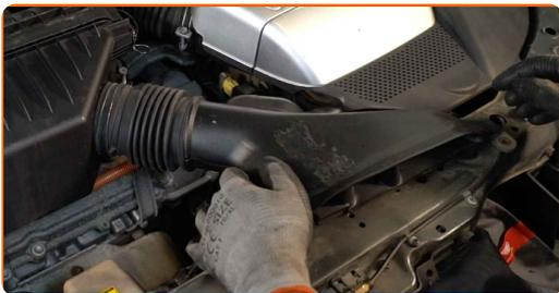
**17** Sichern Sie das Befestigungselement des Luftansaugkanals. Verwenden Sie Stecknuss Nr. 10. Verwenden Sie einen Ratschenschlüssel.
