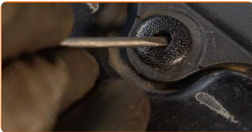
**3** Entfernen Sie die Schutzabdeckung. Verwenden Sie einen flachen Schraubendreher.
