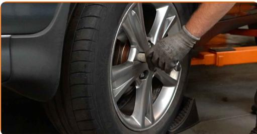
**29** Entfernen Sie den Wagenheber sowie die Unterlegkeile.
