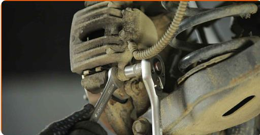
**9** Entfernen Sie die Führungstifte aus dem alten Bremssattel.
