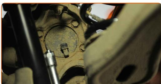
**13** Entfernen Sie die Befestigungsschrauben.
