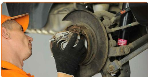
**15** Reinigen Sie den Befestigungssitz der Radnabe. Verwenden Sie Allzweckreinigungsspray.
