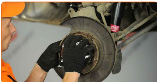
**17** Entfernen Sie die Befestigungsschrauben.
