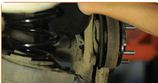
**21** Montieren Sie die neue Brems Scheibe auf der Nabe und schrauben Sie die Befestigungen ein. Verwenden Sie einen Kreuzschlitzschraubendreher.
