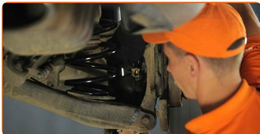
**12** Schrauben Sie die Befestigung ab, die das Radnabenlager mit dem Achsschenkel verbindet. Verwenden Sie Stecknuss Nr. 14. Verwenden Sie einen Ratschenschlüssel.
