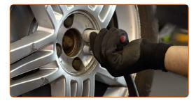
Senken Sie das Auto und ziehen Sie die Radschrauben über Kreuz an. Verwenden Sie eine Schlagnuss für Felgen # 19. Verwenden Sie einen Drehmomentschlüssel. Ziehen Sie ihn mit 110 Nm Drehmoment fest.
