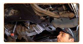
Ziehen Sie das Befestigungselement an, das die Druckstange mit dem Federbein verbindet. Verwenden Sie Stecknuss Nr. 17. Verwenden Sie einen Drehmomentschlüssel. Ziehen Sie ihn mit 44 Nm Drehmoment fest.
