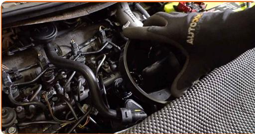
**20** Füllen Sie Öl durch den Einfüllstutzen in den Motor. Erforderliche Menge an Öl: 4.8 l.
