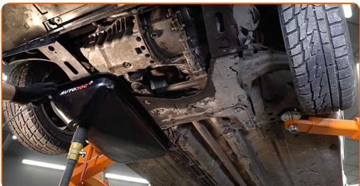
**6** Drehen Sie die Ablassschraube heraus. Verwenden Sie die Vierkantnuss für Ölablassschrauben Nr. 8.
