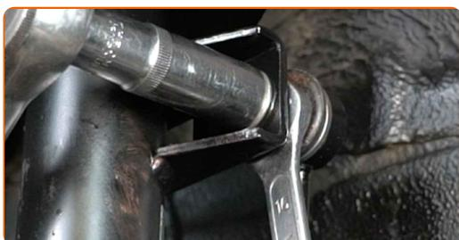
**75** Schrauben Sie die unteren Befestigungen des Federbeins fest. Verwenden Sie Stecknuss Nr. 18. Verwenden Sie einen Drehmomentschlüssel. Ziehen Sie ihn mit 110 Nm Drehmoment fest.
