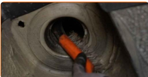
**55** Reinigen Sie die Befestigungen, die das Kugelgelenk mit dem Achsschenkel verbinden. Benutzen Sie eine Drahtbürste. Benutzen Sie WD-40-Spray.
