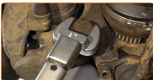
**73** Montieren Sie den Querlenker.
