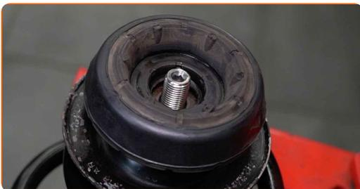
**50** Ziehen Sie die Federbeinkolbenstangenmutter an. Verwenden Sie eine 21 mm Schienenmutterstecknuss. Verwenden Sie Inbusschlüssel Nr. H7. Verwenden Sie einen Drehmomentschlüssel. Ziehen Sie ihn mit 60 Nm Drehmoment fest.
