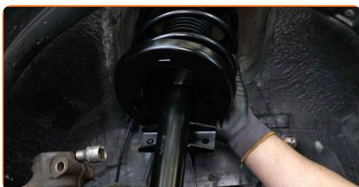
**59** Schrauben Sie die obere Befestigung des Domlagers an. Schrauben Sie diese nicht fest.
