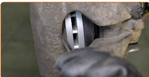
**21** Die Befestigungselemente der Bremssattelhalterung reinigen. Benutzen Sie eine Drahtbürste. Benutzen Sie WD-40-Spray.
