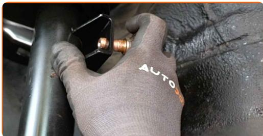
**74** Ziehen Sie das Befestigungselement an, das die Druckstange mit dem Federbein verbindet. Verwenden Sie Ring-Gabelschlüssel Nr. 16. Verwenden Sie Stecknuss Nr. 19. Verwenden Sie einen Drehmomentschlüssel. Ziehen Sie ihn mit 100 Nm Drehmoment fest.
