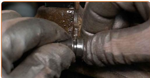
**77** Befestigen Sie den Bremsschlauch am Federbein.
