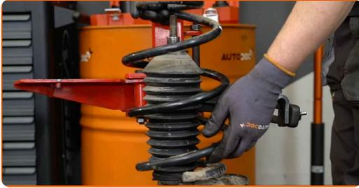
**47** Installieren Sie die Feder am Stoßdämpfer.
