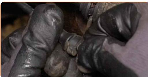
**19** Lösen Sie den Bremsschlauch vom Federbein.
