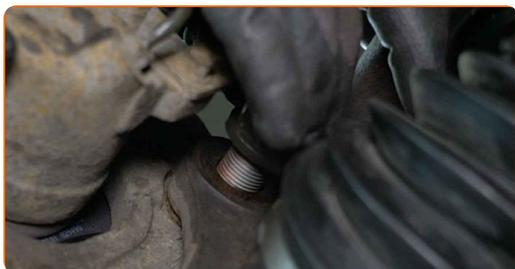
**72** Ziehen Sie die Befestigungen des Bremsattelhalters fest. Verwenden Sie Stecknuss Nr. 27. Verwenden Sie einen Drehmomentschlüssel. Ziehen Sie ihn mit 200 Nm Drehmoment fest.
