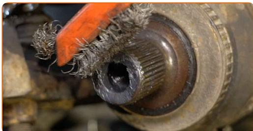
**57** Behandeln Sie die Keilwellen des Antriebswellen-Gleichlaufgelenks. Benutzen Sie ein Kupferschmiermittel.
