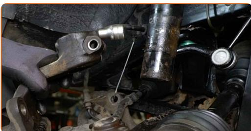
**38** Lösen Sie die obere Befestigung der Federbeinbefestigung.
