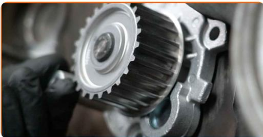
**111** Schrauben Sie die Befestigungen der Wasserpumpe ein. Verwenden Sie Stecknuss Nr. 10. Verwenden Sie einen Ratschenschlüssel.
