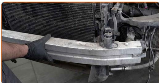
**179** Schrauben Sie die Befestigungen des Bewehrungsstabs des Stoßfängers ein. Verwenden Sie Stecknuss Nr. 13. Verwenden Sie einen Ratschenschlüssel.
