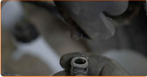
**19** Schrauben Sie die Scheinwerfer-Befestigungen heraus. Verwenden Sie den Torx T27. Verwenden Sie einen Ratschenschlüssel.
