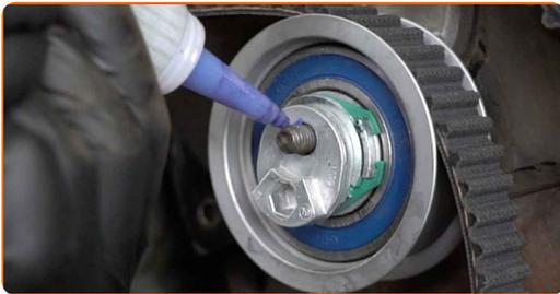
**116** Schraube die Befestigung der Spannrolle des Zahnriemens ein. Verwenden Sie Stecknuss Nr. 13. Verwenden Sie einen Ratschenschlüssel.
