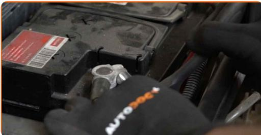
**4** Entfernen Sie die Batterieklemmen.
