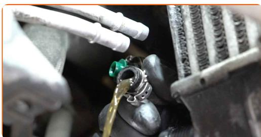
**157** Bringen Sie die Leitungen der hydraulischen Servolenkung an.
