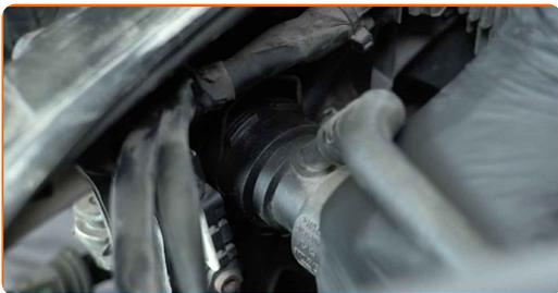
**173** Bringen Sie den Clip des oberen Kühlmittelschlauchs an.
