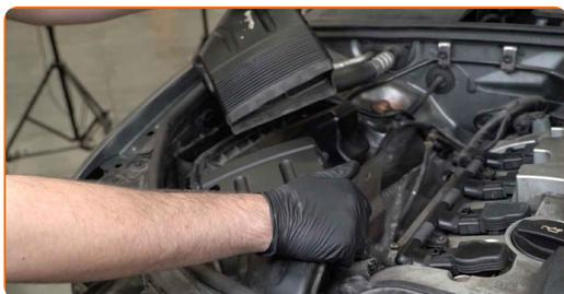
**61** Lösen Sie den Stecker des Motorkühlgebläses.
