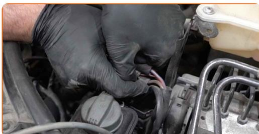
**63** Lösen Sie den Stecker des Motorkühlgebläses.
