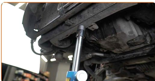
**182** Ziehen Sie die Verbindungselemente des Bewehrungsstabs des Stoßfängers an. Verwenden Sie Stecknuss Nr. 13. Verwenden Sie einen Drehmomentschlüssel. Halten Sie das empfohlene Anzugsdrehmoment ein.
