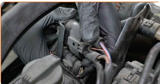
**172** Bringen Sie den oberen Kühlmittelschlauch an.
