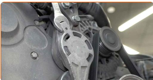
**78** Entfernen Sie den Keilrippenriemen.
