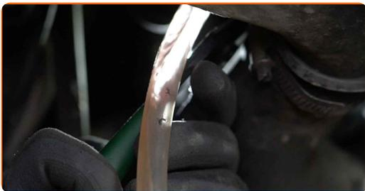
**39** Lassen Sie das Kühlmittel aus dem Motor ab.
