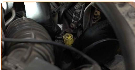
**62** Entfernen Sie die Halterung des Kabelbaums.
