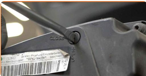
**76** Entfernen Sie die vordere obere Zahnriemenabdeckung.
