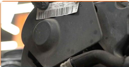
**77** Ziehen Sie die Spannrolle des Keilrippenriemens beiseite. Verwenden Sie Ring-Gabelschlüssel Nr. 17.
