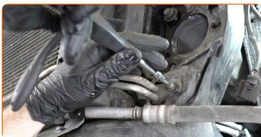
**159** Entfernen Sie das Mikrofaser Tuch von der Luftführung des Ladeluftkühlers.
