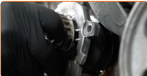
Austausch: Zahnriemensatz mit Wasserpumpe – SEAT Altea (5P1).
