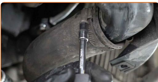
**162** Reinigen Sie die Rohre der Ölkühlleitung des Automatikgetriebes. Verwenden Sie Allzweckreinigungsspray.
