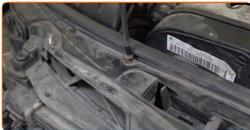
**60** Entfernen Sie den Luftansaugkanal.
