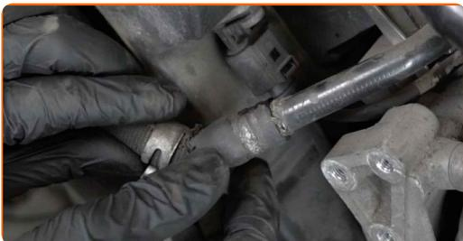
**134** Sichern Sie die Klemme des Kühlmittelschlauchs. Verwenden Sie eine Clic-R-Kragenzange.
