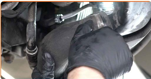
**161** Ziehen Sie die Klemme am Luftansaugschlauch fest. Verwenden Sie Stecknuss Nr. 7. Verwenden Sie einen Ratschenschlüssel.
