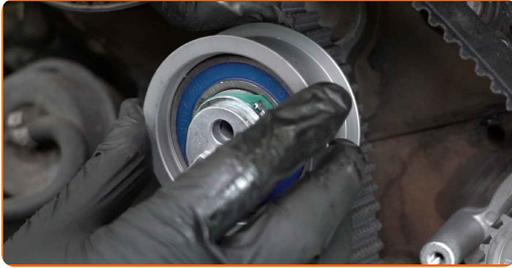
**115** Behandeln Sie die Befestigungsschraube. Verwenden Sie ein Dichtmittel.
