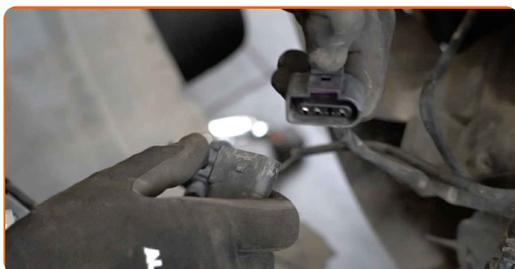
**18** Lösen Sie Leitung der Scheinwerferwaschanlage.
