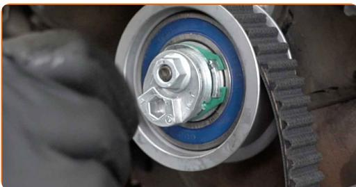
**117** Behandeln Sie die Befestigungsschraube. Verwenden Sie ein Dichtmittel.
